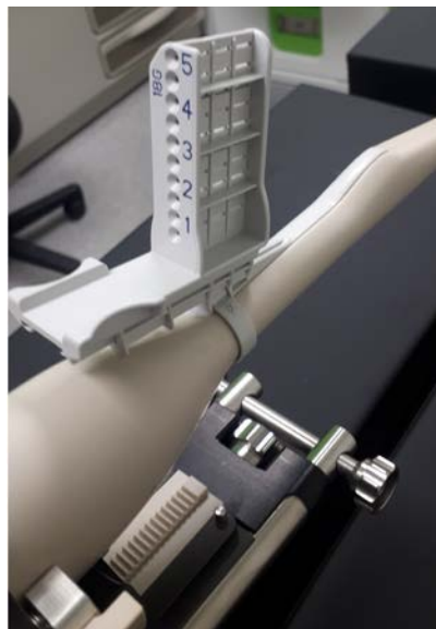
Slika 21: Sonda EV29L z vstavljenim sterilnim transperinealnim vodilom za iglo EV29L (prikazano brez ovoja)
