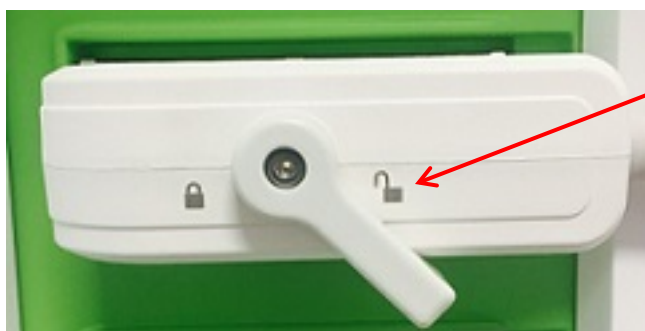
Slika 29: Odklenjen zaklepni gumb konektorja sonde
