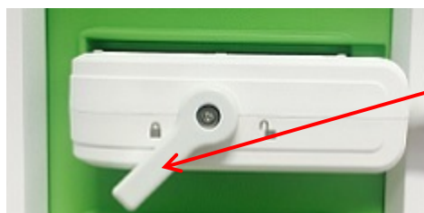
Slika 28: Usmerjenost konektorja sonde
